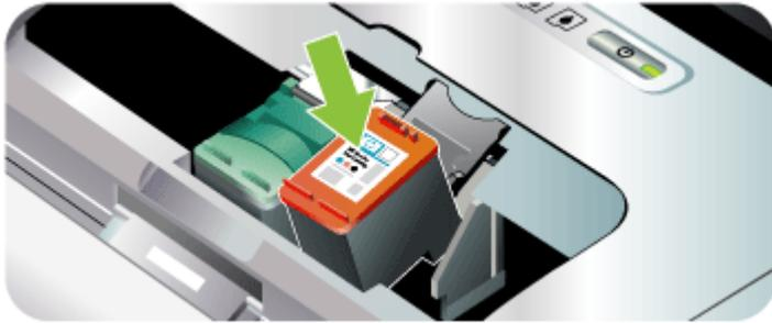
5. 关上打印墨盒的固定锁。如果正确地插入墨盒，则关闭固定锁会将墨盒轻轻地推入底槽。按一下固定锁，确保固定锁已平整地盖在墨盒上。
