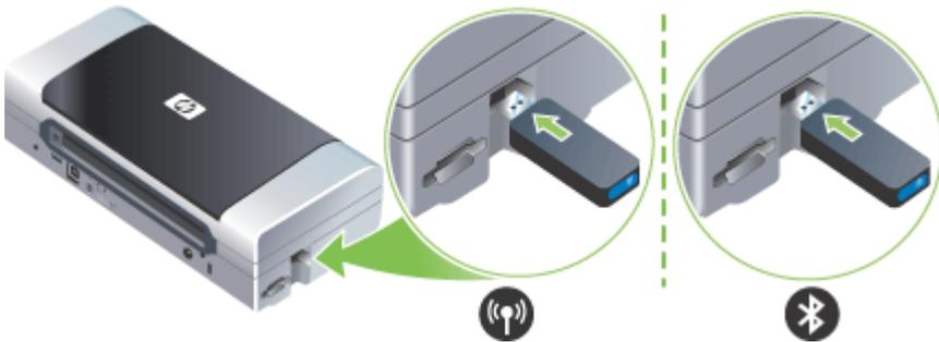
将 HP 802.11 或蓝牙无线 USB 附件插入插槽。
