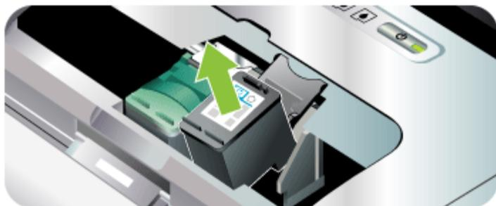
4. 将新的打印墨盒以取出旧的打印墨盒时相同的角度插入底槽。核对固定锁上的符号与打印墨盒上的符号，确保插入的是正确的打印墨盒。
