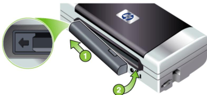
2. 将电池推入电池槽，直到电池喀哒一声到位。
