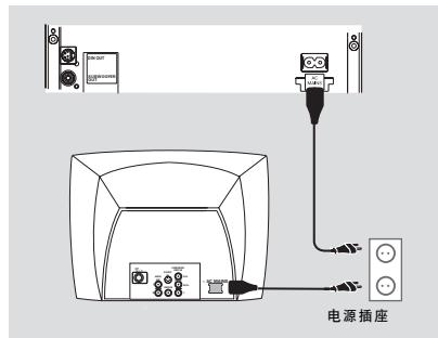
正確完成所有連接之後，將本機的交流電源線插入牆上的交流電源插座中。
