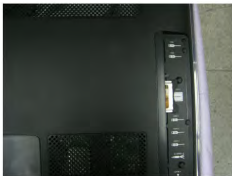
将CAM卡插入电视机PCMCIA插槽2
