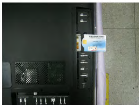
将智能卡插入CAM卡1
