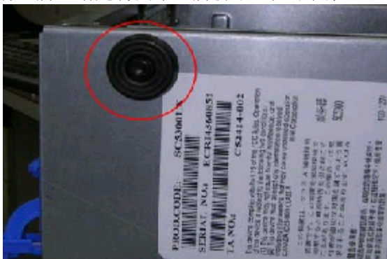
圆明HT460服务器机箱垫脚示意图
