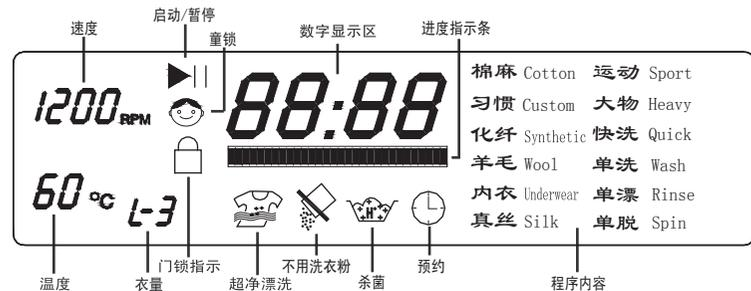
1. 数字显示区: 开机显示旋钮所对应位置的程序, 启动时显示当前设定加热温度和甩干速度, 如“60°C”和“1200rpm”; 运行中显示剩余时间, 自动称量状态显示“Auto”, 衣物自动称量后代码如“AL-1”, 手动选择衣量代码, 如“L-2”; 调整预约时间时显示预约时间数值如“6:00”; 选定童锁时显示“🔒”; 报警时显示故障代码, 如“Err3”; 程序结束显示“End”。
