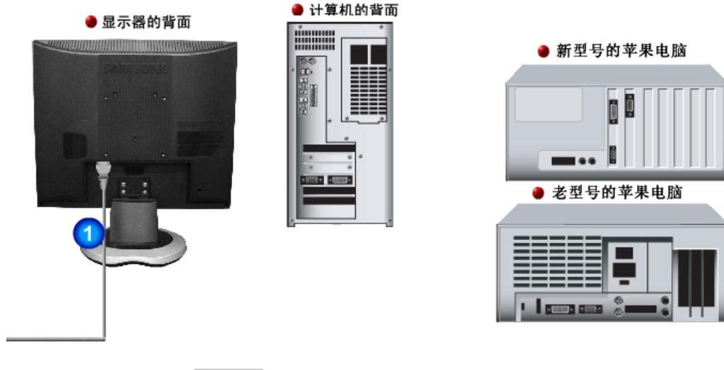
1. 把你的显示器的电源线连接到显示器背面的电源端口。
