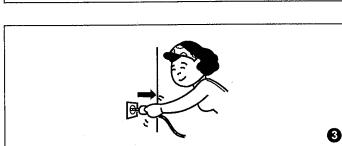
③ 安裝接地線、排水管換邊或檢修洗衣機時，請先拔掉插頭，以策安全。
