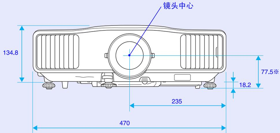
\* 镜头中心到悬吊支架固定点的距离
