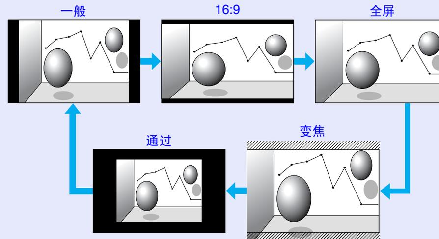
■ 改变计算机图像 / HDMI 图像的外观（只适用于 EB-G5350 / G5300 / G5150 / G5100）
