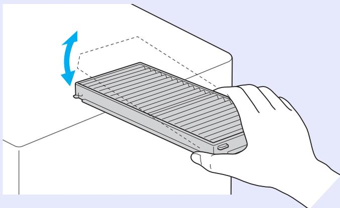
**4** 使用真空吸尘器清洁前面，从而清除空气过滤器上的任何灰尘。
