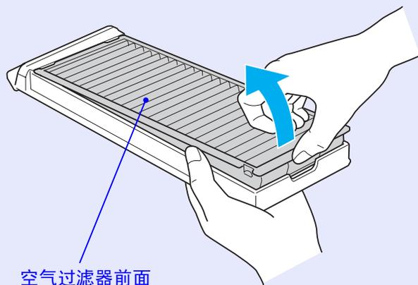
**3** 使空气过滤器的前面朝下，轻敲四或五次抖落灰尘。将其翻转，以相同的方式轻敲另一面抖落灰尘。
