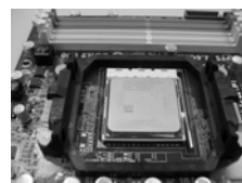
步骤 4: 下推并锁住插座拉杆
