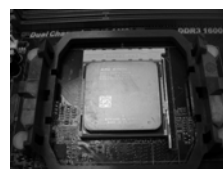
步驟 4： 下推並鎖住插座拉桿
