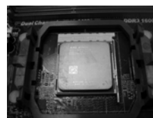
FASE 4: Abbassare e bloccare la levetta socket
