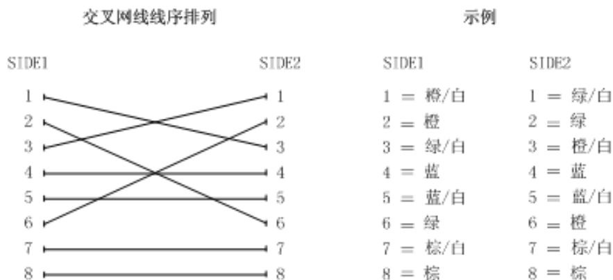
图 C-3 交叉网线制作示例图
