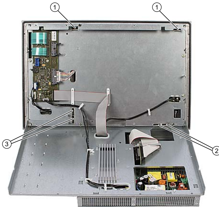
图片 1-3 带有用于标签条的接头和插槽的设备后部
