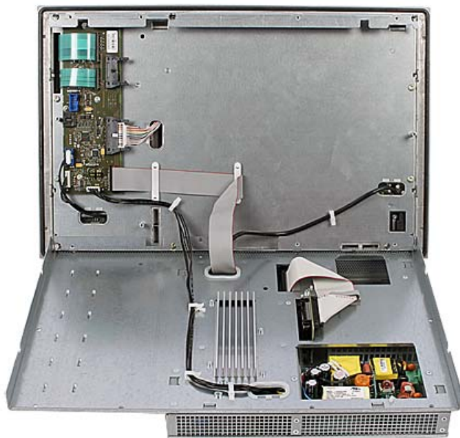
图片 1-2 实例 12" 触摸屏设备：将计算机单元与控制单元分离
