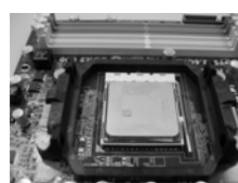
步驟 4： 下推並鎖住插座拉桿
