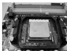
步骤 4： 下推并锁住插座拉杆
