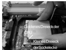
SCHRITT 2 / SCHRITT 3: Richten Sie das goldene Dreieck der CPU mit dem kleinen Dreieck der Sockelecke aus
