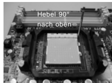
SCHRITT 1: Ziehen Sie den Sockelhebel hoch
