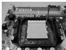
PASO 1: Levante la Palanca del Zócalo
