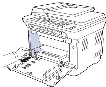
5. 使用成像装置前端的凹槽将其从机器中拉出。
