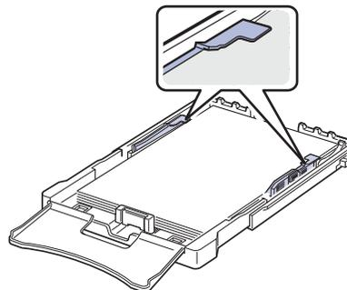
7. 捏住并滑动纸张长度导板，直到它轻轻触及纸叠的末端。
