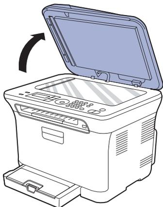
2. 将原件正面朝下放置在扫描仪玻璃板上，使其与玻璃板左上角的定位指示对齐。
