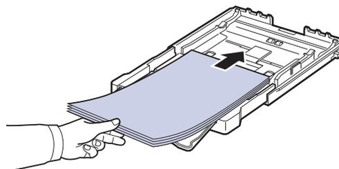
请确保纸盒没有过满，纸张的四个角在纸盘内放置平整，并处于边角固定架的下方，如下所示。纸盒过满会导致卡纸。
