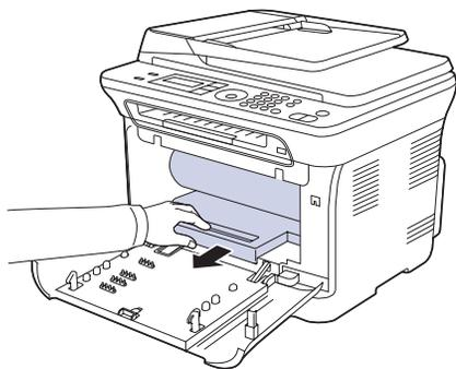
6. 打开新成像装置的包装。取下成像装置两侧的保护装置，并撕掉保护其表面的包装纸。
