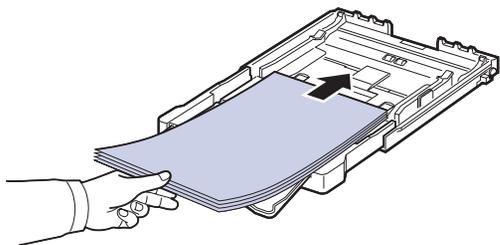
4. 滑动纸张长度导板，直到它轻轻触及纸叠的末端。捏住纸张宽度导板，将其滑到纸叠的边缘且不让纸叠弯曲。
