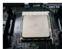
FASE 4: Abbassare e bloccare la levetta socket
