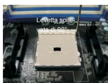
FASE 1: Sollevare la levetta socket
