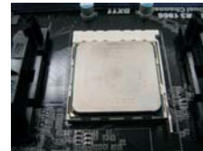
步驟 4： 下推並鎖住插座拉桿
