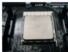
ШАГ 4. Прижмите и зафиксируйте рычаг гнезда.
