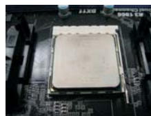
步骤 4: 下推并锁住插座拉杆
