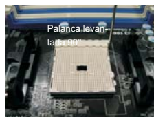
PASO 1: Levante la Palanca del Zócalo
