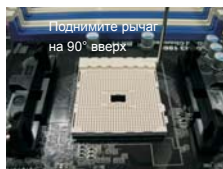
ШАГ 1. Поднимите рычаг гнезда.
