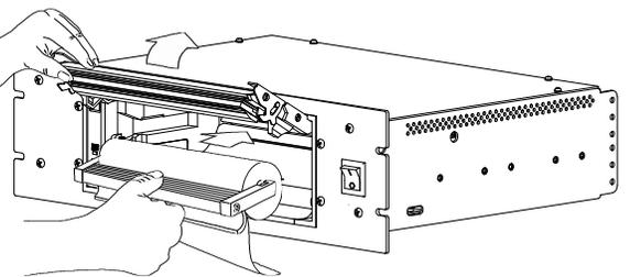
最后将托架重新插入打印机，合上机门。
