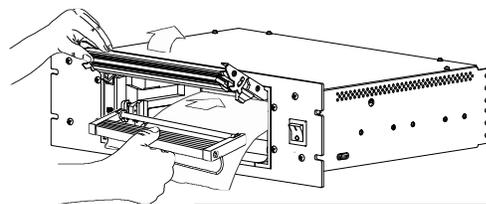
注意：打印纸托架必须放置在打印机内，以保证打印纸能够像内置纸卷一样遮住缺纸探头和打印纸标记探头。
