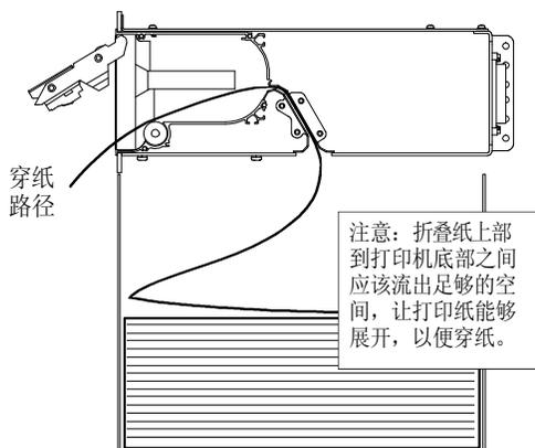
如图所示，从底部穿入打印纸，并从打印机门将打印纸穿出。
