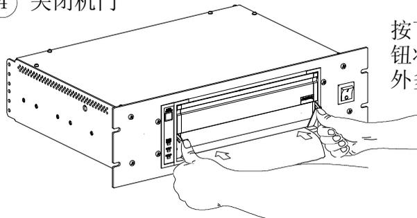
按下机门销上的空心圆形按钮将机门锁住后，撕掉机门外多余的打印纸。
