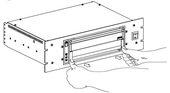
② 取出打印纸托架
