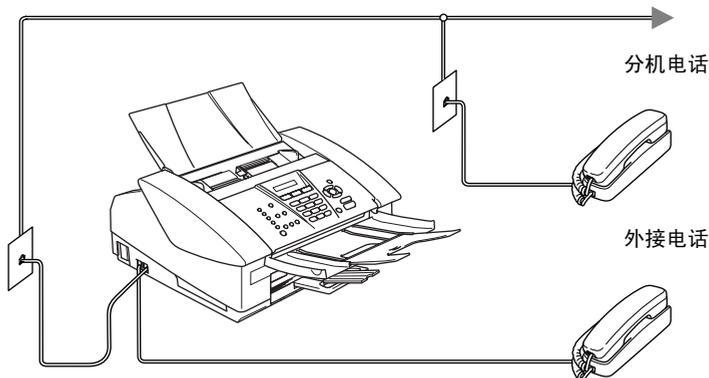
使用外接应答设备时，屏幕显示 Telephone（电话）（仅 MFC-3240C）或 Ext. Tel in Use（外接电话使用中）（仅 FAX-1840C）。
