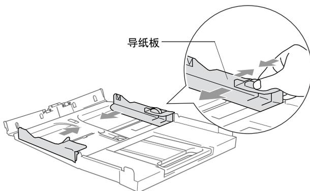
3 拉出纸张支撑板，然后展开托纸板。
