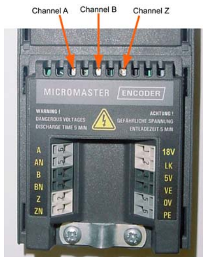
图 15-5 编码器模板上的 LED 指示灯
