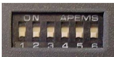
图 15-6 编码器模板的 DIP 开关
