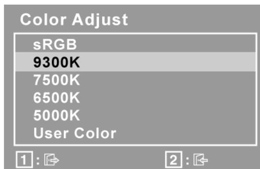
**sRGB-** 是一种颜色管理的工业标准, 它支持很多最新的应用程序。启用此设置, LCD 可以更精确地显示原始色彩。启用 sRGB 设置后将关闭 Contrast(对比度) 和 Brightness(亮度) 调整。
