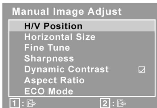
**H./V. Position**（水平 / 垂直位置）将屏幕图像左右移动或上下移动。
