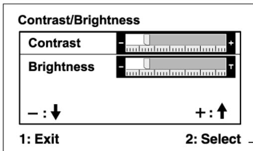
控制屏幕底部的命令行显示在此屏幕之后下一步要做什么。可在控制屏幕之间切换、调节选择的选项或者退出屏幕。
