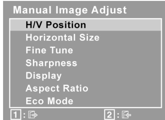
**H.V. Position (水平 / 垂直位置)** 將螢幕影像左右移動或上下移動。
