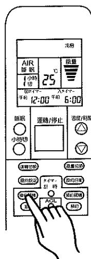
1 當“預約關機”鍵被按下時，預約時間顯示且“預約關機”符號閃爍，表示已進入預約關機設定狀態。此時可調整“時間上升”及“時間下降”去設定所希望的關機時間。
