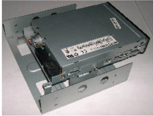
3. 用4颗螺丝将两条5.25英寸设备滑轨固定到铁架两侧，设备前沿应突出导轨前沿1cm左右；
