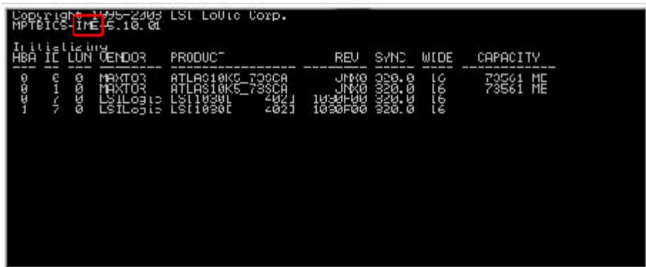
如果要调整成为支持HostRaid0则将(BIOS->Advanced->PCI Configuration->Onboard SCSI Mode->IM/IME) 改为 (BIOS->Advanced->PCI Configuration->Onboard SCSI Mode->IS)
