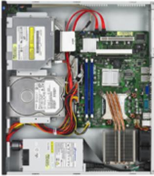
华硕 RS100-X5/PI2 服务器出色的电路设计，使得服务器整体能量消耗低于 1A，即使 180W 的小功率电源也足以应付用户应用。
