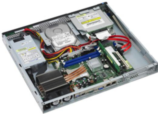
华硕 RS100-X5/PI2 服务器支持 Intel Xeon 3000 系列, Conroe-L 400 系列和 Intel Core2 Duo 等处理器。主板采用 Intel 945GC+ICH7 芯片组, 支持两组 SATA II, 提供 PCI-E x16 扩展槽, 支持全高/半长插卡, 华硕 RS100-X5 服务器配备两个 Marvel 8056 千兆网络控制器, 搭配双网卡 Teaming, 为用户提供快捷并可靠的网络连接功能。
