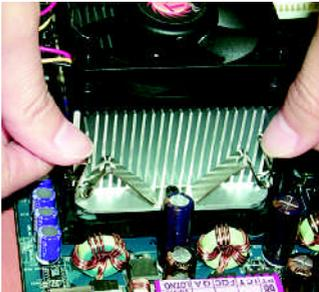
1. 先將CPU散熱風扇一邊的卡榫以平均施力的方式往下壓，直至扣緊為止；以同樣方式再將另一邊卡榫扣緊。
