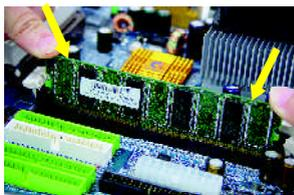
3. 將卡榫向內推，確實卡住記憶體模組 DIMM。一旦固定位置，兩旁的卡榫便自動卡住記憶體模組予以固定。試著輕輕搖動記憶體模組，若不搖晃則裝置成功。
