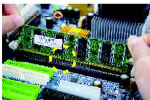
2. 扳開記憶體模組插槽卡榫，以平均施力的方式，將記憶體模組下壓推入插座。記憶體模組插入定位後，將卡榫向內按至卡住。
