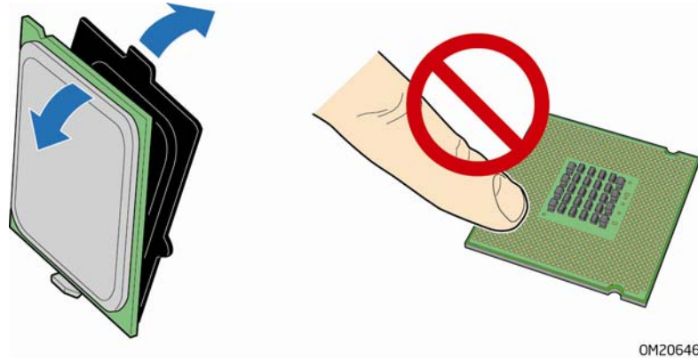
图 12. 从处理器保护罩中取出处理器
