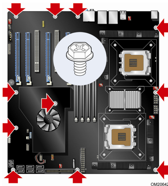
图 8. 台式机主板 D5400XS 安装螺丝孔位置
