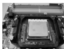
FASE 4: Abbassare e bloccare la levetta socket
