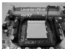
PASSO 1: Levantar o Nível de Tomada Até 90°
