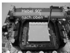
SCHRITT 1: Ziehen Sie den Sockelhebel hoch
