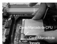
PASSO 2/PASSO 3: Apropria o Canto Marcado de CPU ao Canto Marcado de Tomada
