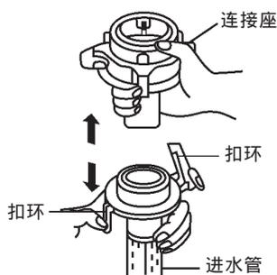
**2** 将上连接头上的四颗固定螺钉拧松, 旋转下连接头, 使上下连接头间有 3 个螺纹的间隙。
