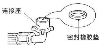
**2** 将进水管连接座垂直安放在进水管口上。
