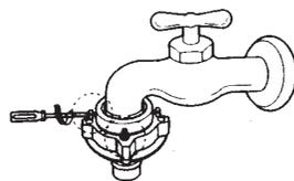
**6** 旋转下连接头直到上下连接头拧紧为止 (如未拧紧, 会发生漏水)。旋转后, 上下连接头之间的间隙在 3mm 以下。
