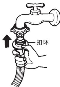
**9** 确认下连接座与进水管连接
