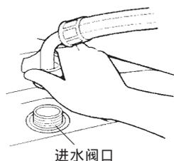
**3** 顺时针缓慢旋紧进水管连接座, 以确保进水管连接座与进水管连接牢固。
