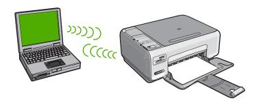
要将 HP All-in-One 连接到计算机 (ad hoc),您需要在计算机上创建 ad hoc 网络配置文件。这包括选择 ad hoc 网络的网络名称 (SSID) 和 WEP 安全(是可选项,但建议您选择)。
