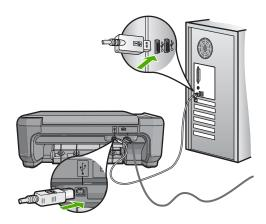
有关安装软件及连接 USB 电缆的详细信息,请参阅 HP All-in-One 随附的《安装手册》。
