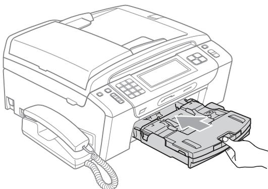
9 将纸盒装入到位的同时，拉出纸张支撑板 (①) 直至其卡入到位，然后展开纸张支撑翼板 (②)。
