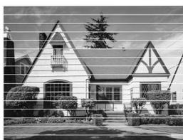
当打印头喷嘴阻塞时，打印图样将如上图所示。
