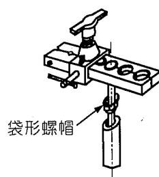
擴管前須先將銅管毛邊削除，用活動扳手取下二方閥或三方閥上之袋形螺帽，放入銅管以進行擴管工作。
