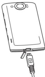
3. 将充电器插入电源插座开始充电。
