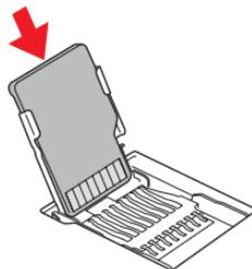
7. 放倒卡匣，将其沿箭头方向推动直至锁定。
