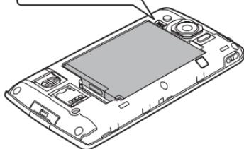
5. 使电池上有字的一面朝上，根据电池前端的形状正确安装电池。
