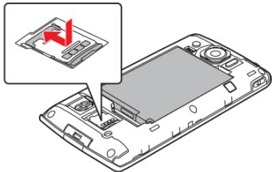
5. 提起卡匣，取出原来安装的SD卡。
