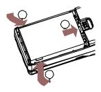
进行 4 个步骤: ①将弹簧扣沿箭头方向向上推开; ②拿起电池盖; ③将电池沿箭头方向向上推动; ④ 勾起电池凸缘从而取出电池。
