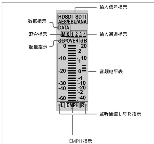
**输入信号指示:** 指示为相应音频输入通道所选择的当前输入信号 (HDS DI、SDTI、AES/EBU 或模拟 ANA)。
