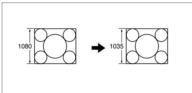
**1080=>1035 ( CROP ):** 有效扫描行由 1080 转换为 1035。剪切顶部、底部、左侧与右侧，然后水平拓展图像。
