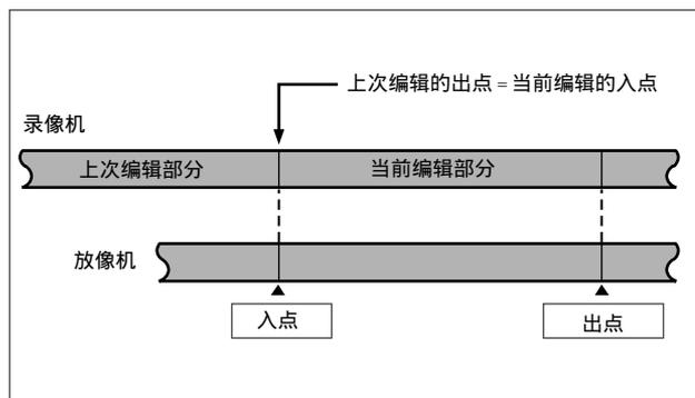
完成第一个编辑部分自动编辑后，按下列步骤执行连续编辑。
