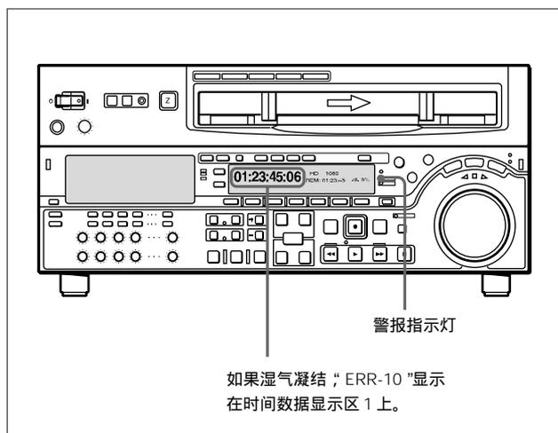
如果发生这种情况，磁鼓与主导轴电机停止运行，自动弹出录像带。然后，磁鼓开始转动，以干燥表面。在此状态下，本设备不能运行。当湿气蒸发完时，错误信息消失，警报指示灯熄灭。
