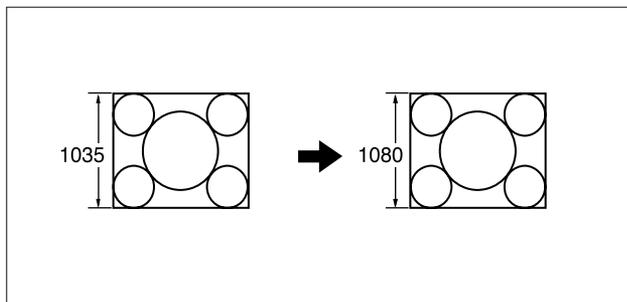
**1035=>1080 ( PANEL ):** 有效扫描行由 1035 转换为 1080。1035 行插入 1080 行中，然后水平压缩图像。
