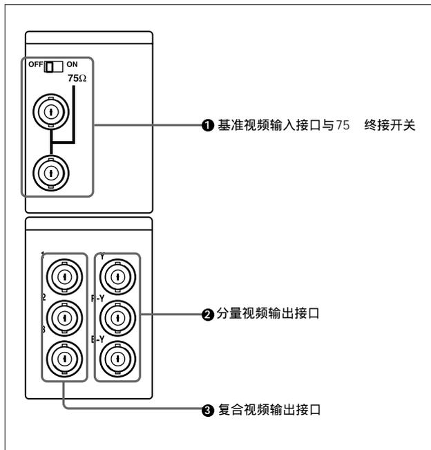
**1 基准视频输入接口 (BNC 型) 与 75Ω 终接开关**
