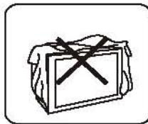
在开机看电视时，电视机上不可覆盖织物等影响散热物品，以防造成电视机散热不良，直接影响电视机使用寿命或引起故障，甚至着火。盖电视机罩时务必确认拔掉电源插头。
