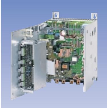
在标准情况下,在基本装置调速器中,电子箱灵活地允许插入通讯模块和工艺模块。
