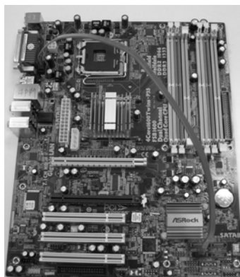
Collegare il cavo dati SATA al connettore eSATAII (eSATAII)
