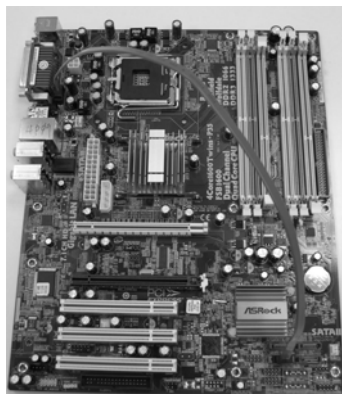
将 SATA 数据线连接到 eSATAII 接口(eSATAII)
