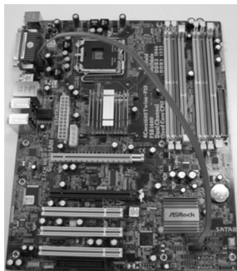
Verbinden Sie das SATA-Datenkabel mit dem orange eSATAII-Anschluss (eSATAII)
