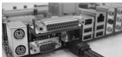
Collegare un'altra estremità del cavo della periferica eSATAII alla porta eSATAII dello schermo I/O
