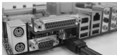
将 eSATAII 设备连线的另一端连接到 I/O 挡板的 eSATAII 设备
