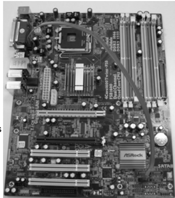
Connectez le câble de données SATA au connecteur SATAII (eSATAII)
