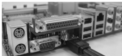
Connectez l'autre extrémité du câble de périphérique SATAII au port eSATAII du blindage entrée/sortie.
