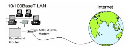
注:在使用过程中,Modem、路由器、计算机开机顺序应为:先开启Modem电源,待Modem启动完成后(约1分钟)开启路由器电源,而后再开启计算机电源。
