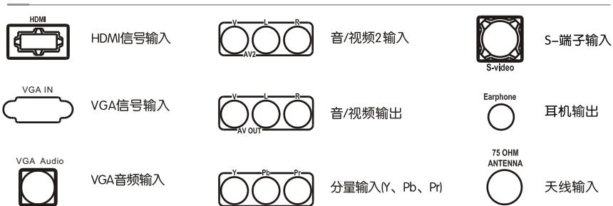
备注：1、视频1输入与S-端子输入共用音频输入端口，故二者不能同时使用。
