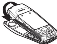
5. 要重新装入手机后盖, 请先使其对准前盖上的卡锁, 然后滑动后盖直至锁定到位。请参见第3页的“安装SIM卡和电池”。
