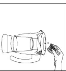
4. 将量杯旋入搅拌杯盖上的加料口中，旋紧为止(如果之前没有从杯盖上拿下则无此动作)。
