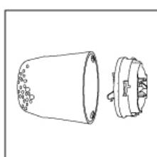
2. 将拧紧的干磨/绞肉刀座与干磨/绞肉杯翻转过来，放到主体上，并按顺时针方向拧紧，将它和主体固定装牢。
