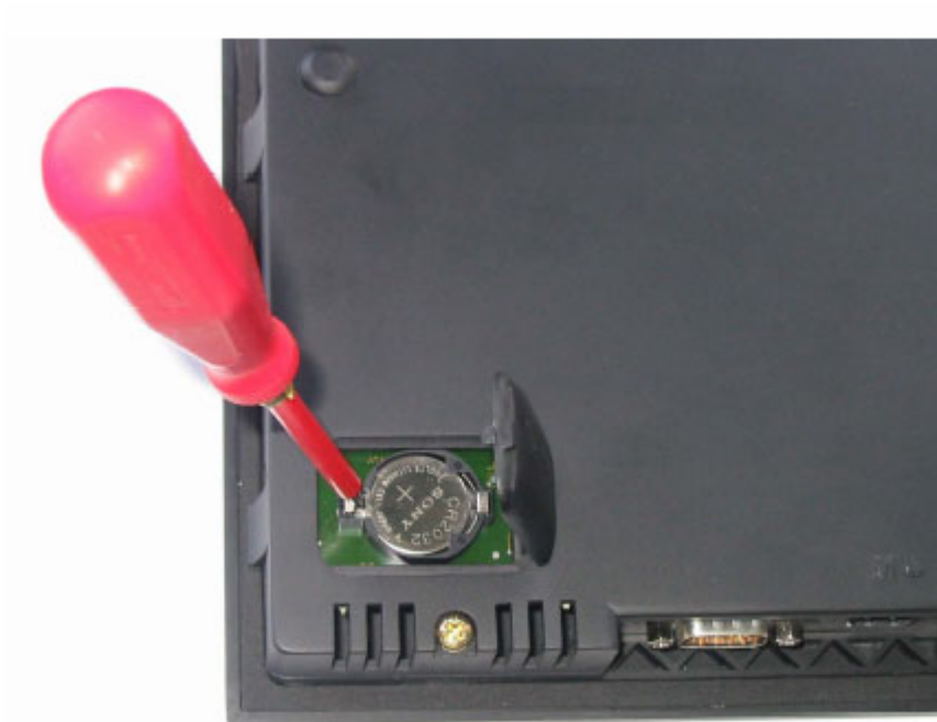
图 11-17 变频调速柜操作面板中备用电池的更换
