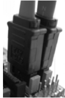
SATAデータケーブルを赤いSATAIIコネクタ(SATAII_RED(PORT1))とオレンジのSATAIIコネクタ(SATAII_ORANGE(PORT2))の両方に接続します
