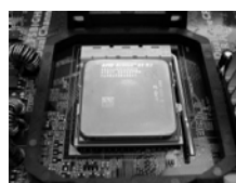
FASE 4: Abbassare e bloccare la levetta socket
