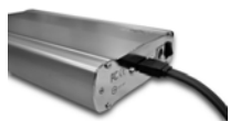
eSATAII デバイスケールの一方の端を eSATAII デバイスに接続します
