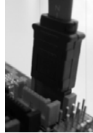
将 SATA 数据线连接到红色的 SATAII 接口 (SATAII_RED(PORT1))
