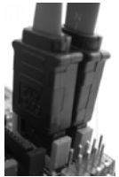
将 SATA 数据线连接到红色的 SATAII 接口 (SATAII_RED(PORT1)) 和橙色的 SATAII 接口 (SATAII_ORANGE(PORT2))
