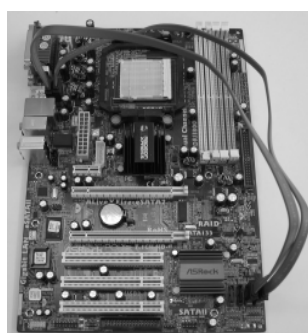
Collegare i cavi dati SATA ai connettori eSATAII rosso (eSATAII_BOTTOM) ed arancione (eSATAII_TOP)
