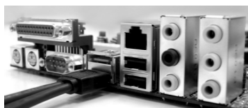
eSATAII デバイスケールのもう一方の端を I/O シールドの eSATAII ポートに接続します
