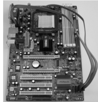
SATAデータケーブルを赤いeSATAIIコネクタ(eSATAII_BOTTOM)とオレンジのeSATAIIコネクタ(eSATAII_TOP)の両方に接続します
