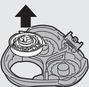
**5** Remova e limpe uma cabeça de corte por vez. Cada cabeça de corte consiste em um cortador e um protetor.
