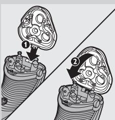
**7** 將電鬍刀組的突耳插入電鬍刀頂端的凹槽 (1)，然後蓋上電鬍刀組 (2)。
