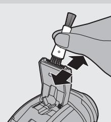
提示：为获得最佳修剪性能，请每隔六个月用一滴缝纫机油润滑修剪器齿。
