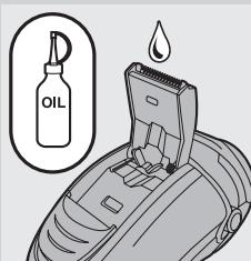
*Tip: Agar performa pemangkas optimal, lumasi gigi-gigi pemangkas dengan setetes minyak mesin jahit setiap enam bulan.*
