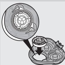
注意：確定電鬍刀刀頭的凸出部分準確地安裝於凹處。
