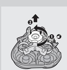
**4 以逆時針方向轉動鎖扣 (1)，並移除固定架 (2)。**
