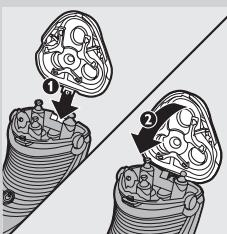
**7** 将剃须刀头部件的凸缘插入剃须刀顶部的槽内 (1)。然后关闭剃须刀头部件 (2)。
