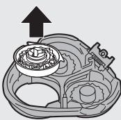
**5** 一次取下並清洗一個刀頭。每個電鬍刀刀頭都是由刀片和刀網組成。
