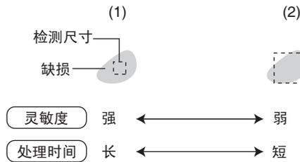
上图(2)中，由于将缺损以外的密度也计算在内，因此与没有缺损的部分的差异较小。换言之，检测范围中所含背景成分越多，灵敏度就越低。
