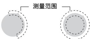
测量范围</p> <ul style="list-style-type: none"><li>· 范围检查<br/>需要检查被测物体全身的缺陷时选择。<br/>最多可以组合描绘5个图形（长方形、椭圆、圆形、多角形）。</li></ul> <p>
