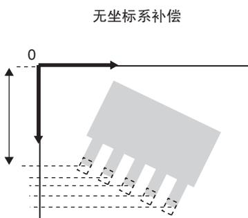
直接以输入图像的坐标来输出位置信息。
