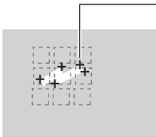
在各个细分的范围中测量缺损度，将超过缺损度阈值的范围作为缺损数量输出。
