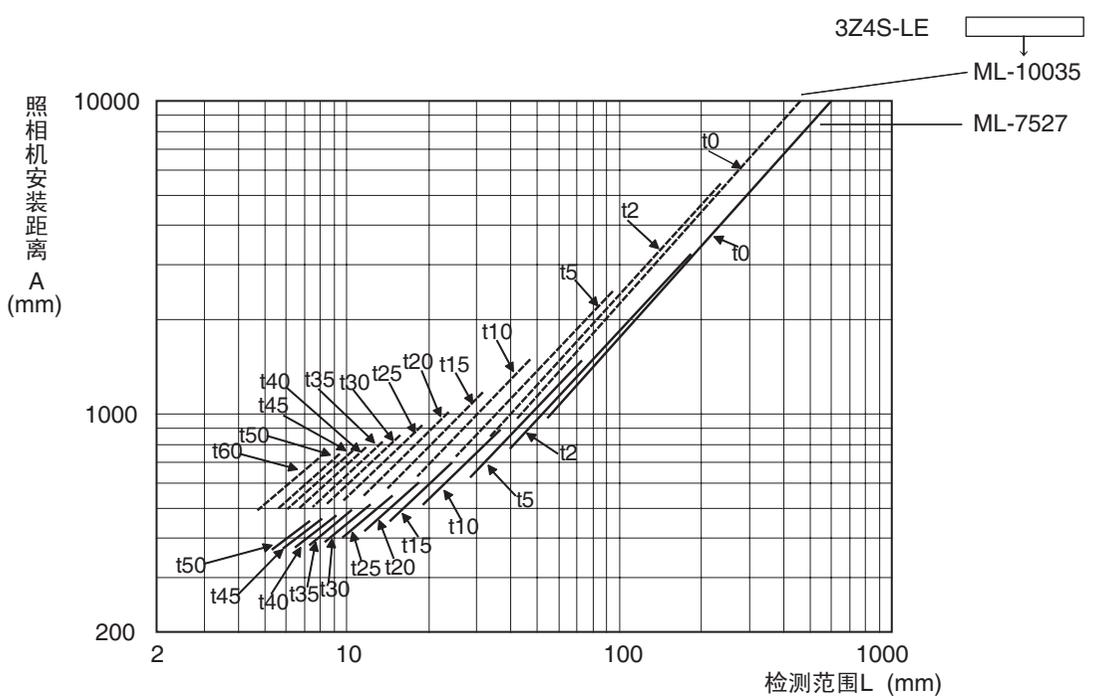
光学图表的横轴为检测范围L (mm)，纵轴为照相机安装距离A (mm)。光学图表所表示的是各型号CCTV镜头的检测范围与安装距离的关系。不同型号镜头的数值不同，因此请仔细确认型号后再查阅光学图表。关于应当使用的调焦延伸管的厚度，光学图表上的点旁有「t5.0」等标识。无需调焦延伸管时为「t0」，使用5mm调焦延伸管时为「t5.0」。
