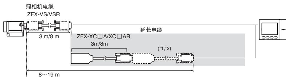
\*1: ZFX-XC A/XC AR 最多可以连接两根电缆。
