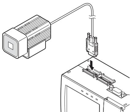
1 将照相机接口插入到控制器的照相机接口内
