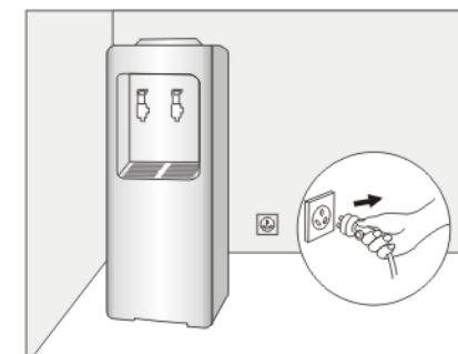
※ 若长时间不使用本机，请把电源插头拔掉，并通过排水口将机内余水全部放完。当电器处于冰点以下环境，导致机器出现冰堵情况时，需关闭制冷开关4小时后，才能打开制冷开关继续工作。
