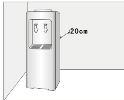
※ 将饮水机放于室内阴凉干燥的稳定的平面，且底部不能垫泡沫、纸板等杂物，以免水分积聚而导致漏电。并避免阳光直射。机背与墙壁至少有20cm的距离，机器旁禁止放置易燃物品。该机不适用于户外或在可能有水喷溅的地方使用。
