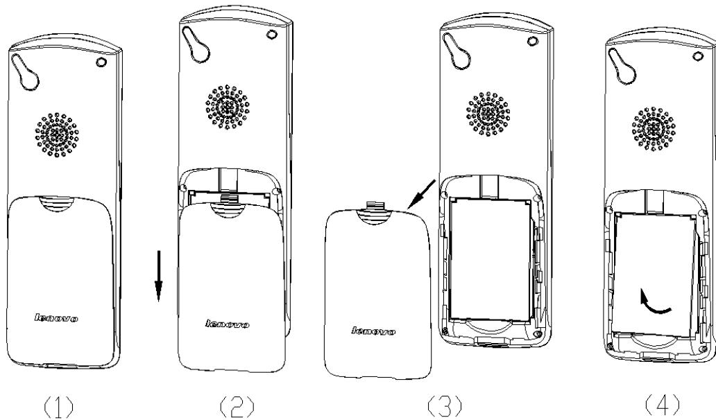
**警告：**拆卸电池之前一定要将手机关机并移去外部电源。绝对禁止在开机的情况下直接取出电池，否则可能损坏 SIM 卡和手机。
