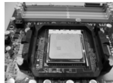
步骤 4: 下推并锁住插座拉杆
