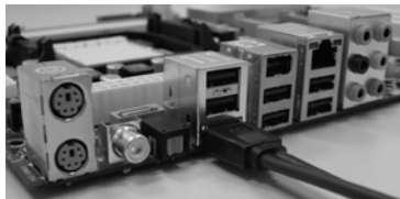
eSATAII デバイスケーブルのもう一方の端を I/O シールドの eSATAII ポートに接続します
