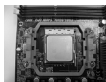
步骤 4： 下推并锁住插座拉杆
