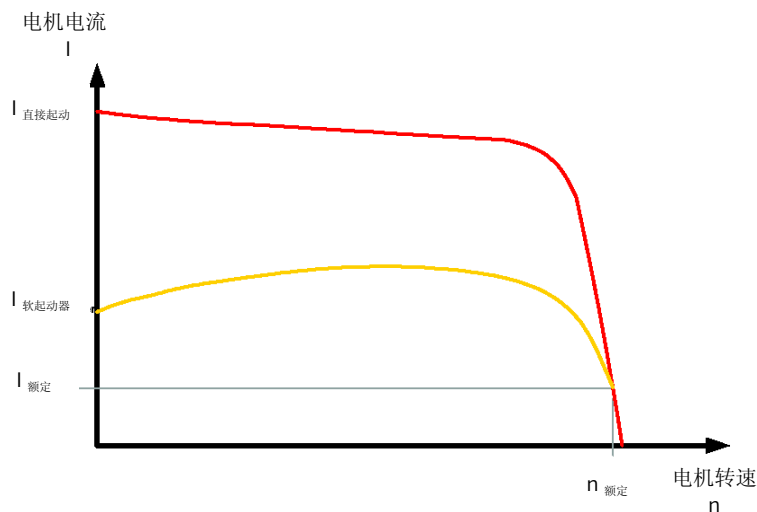
插图 1-3: 使用 SIRIUS 软起动器 3RW44 进行起动时，三相交流异步电机的电流下降特性
